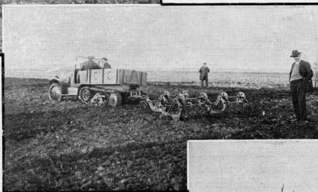
A droite : L'Autochenille tire une charrue bi-soc à relevage automatique.
