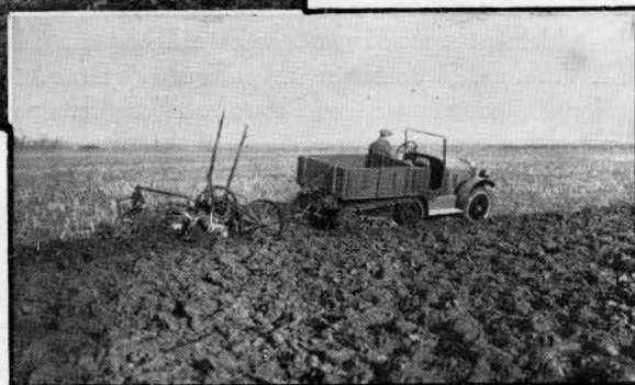
A droite : L'Autochenille tire une charrue bi-soc à relevage automatique.
