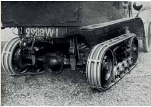
Krybebånd af gummi, støbt i ét stykke, og bagakslen på en K1.
