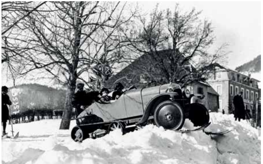
Sådan én her må hedde en "Vintersports-Kégresse"! Udover det smarte karrosseri er bilen udstyret med særlige brede krybebånd og påmonterede ski til snekørsel.
