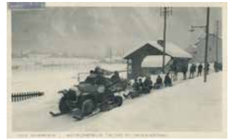
Sådan én her må hedde en "Vintersports-Kégresse"! Udover det smarte karrosseri er bilen udstyret med særlige brede krybebånd og påmonterede ski til snekørsel.
