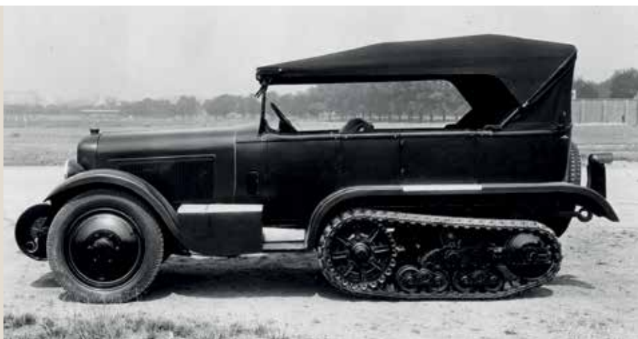
Så bliver de vist ikke flottere! Den hurtige, 6-cylindrede P19 som stabsvogn i det franske militær. Bemærk den lange motorhjelm og bæltedrevet med forskellige størrelser hjul. Bortset herfra ligner den lillesøster P17 på foregående side.
