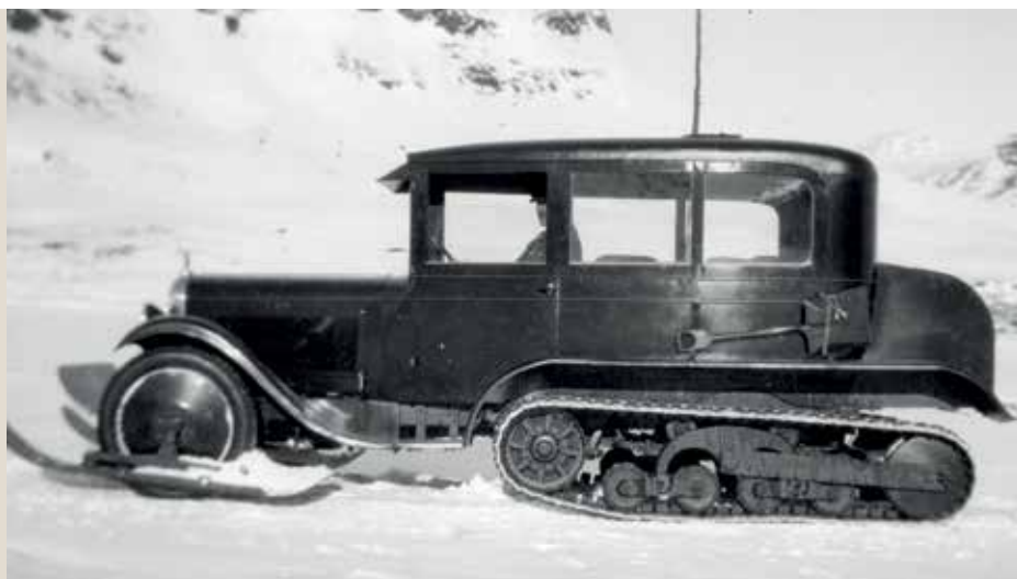
Til venstre et lækkert foto fra 1930: Tre stk. P15N chassiser i Scandiagade, foran Citroëns udstillingsbygning. Efter klargøring gik vognene til Norge og fik karrosserier der (foto ovenfor). Bilerne blev brugt som rutebiler i fjeldene om vinteren. Ingen af dem vides at have overlevet.
