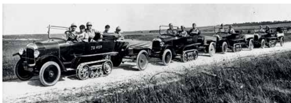
Tidlige K1-modeller fra det franske militær – vognene er specielle, med kun tre ruller ved krybebåndene. Normalt er der fire. Ca. 1921.
