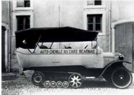
Krybebånd af gummi, støbt i ét stykke, og bagakslen på en K1.
