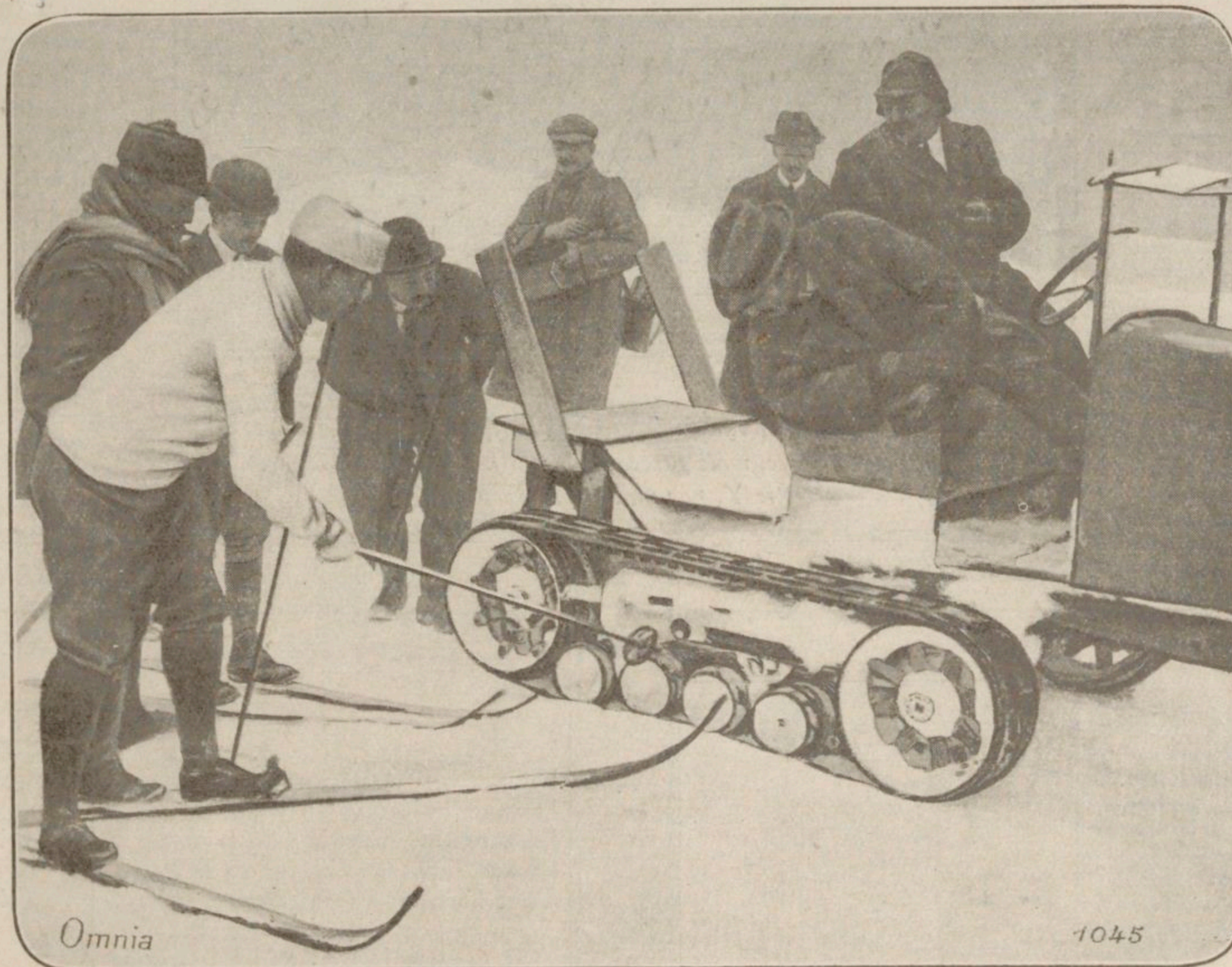
AU SOMMET DU REVARD : M. BORREL, DÉPUTÉ DE LA SAVOIE (EN CHANDAIL BLANC), EXAMINE LE DISPOSITIF KEGRESSE DONT EST MUNIE LA CITROËN DE M. HINSTIN.
