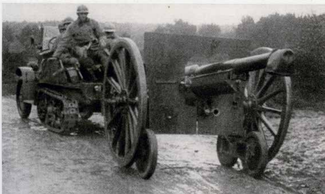
Pièce de canon de 75 \frac{m}{m} sur train rouleur attelée à un tracteur Citroën-Kégresse, type P-17 (moteur 4 cylindres).
