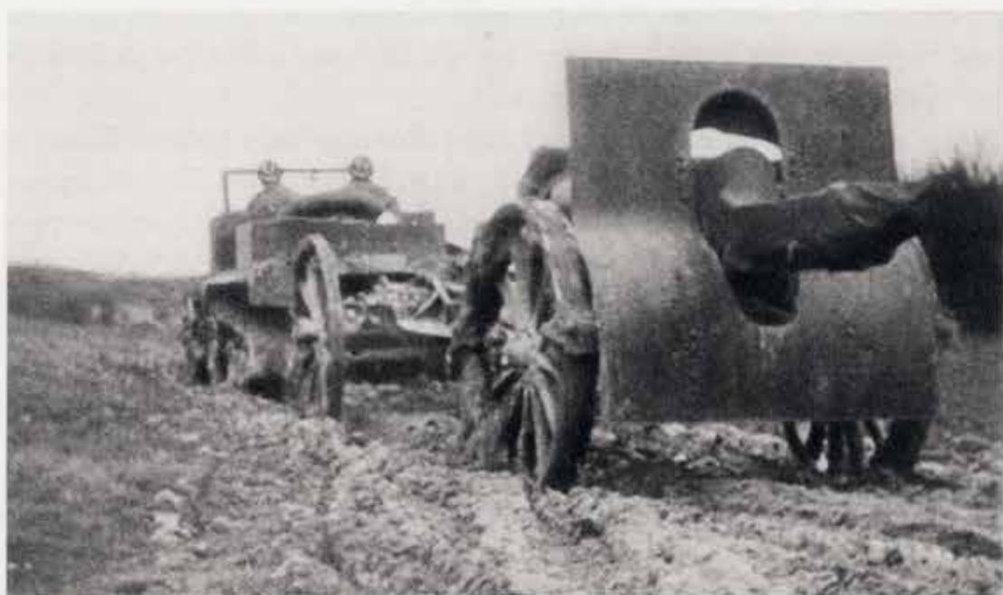
Pièce de 155 \frac{m}{m} attelée à un tracteur Citroën-Kégresse, type P-14 (moteur 6 cylindres).
