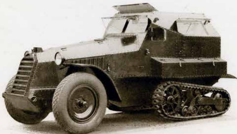
Auto blindée type P-20-C — Moteur Citroën 6 cylindres.
