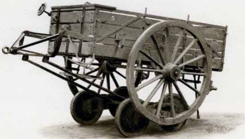
Train rouleur omnibus fixé sur la jante.
