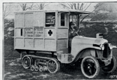
Ambulance sur châssis Citroën-Kégresse 10 CV
