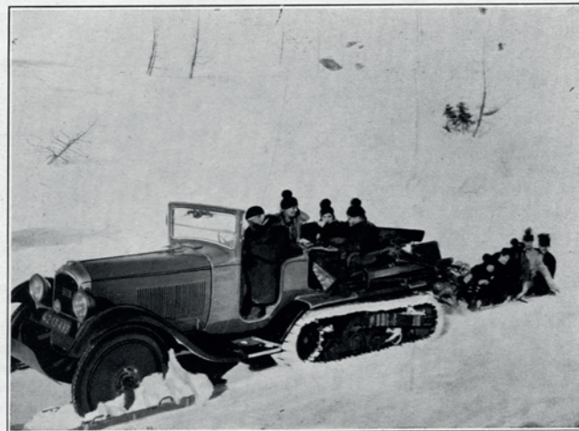
L'autochenille six-cylindres Citroën-Kégresse et sa remorque-toboggan dans la neige
