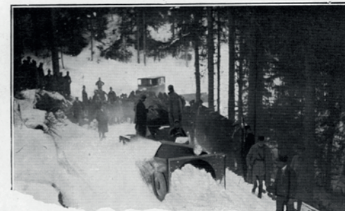
L'appareil Roul à chasse-neige par turbine
