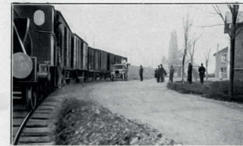
Traction d'un train de 76 tonnes par une autochenille Citroën-Kégresse
