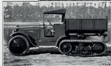
Benne basculante montée sur châssis à chenilles
