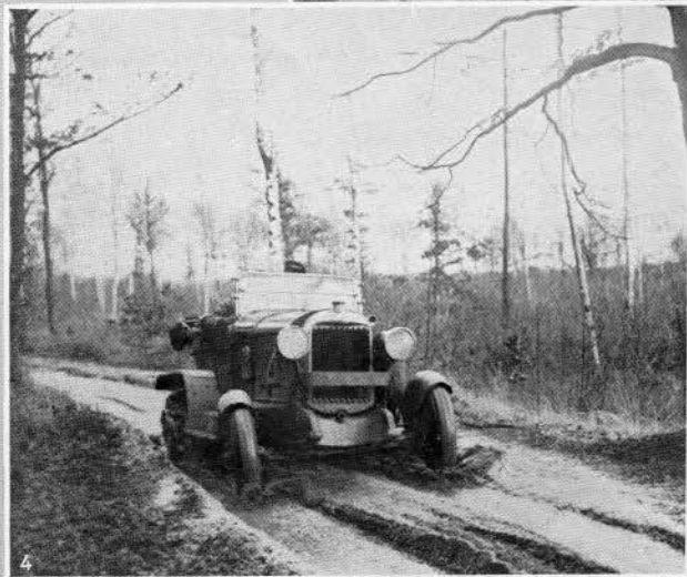
SATORY. — 1, 2 et 5 — Autochenille 10 HP Citroën (type liaison) évoluant sous bois. 3 et 4. — Autochenille 15 HP Citroën (type Reconnaissance) roulant à toute vitesse dans la boue.
