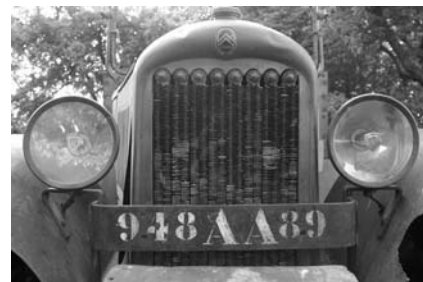
Den meget specielle køler har 8 separate enheder der kan udskiftes hver for sig.
