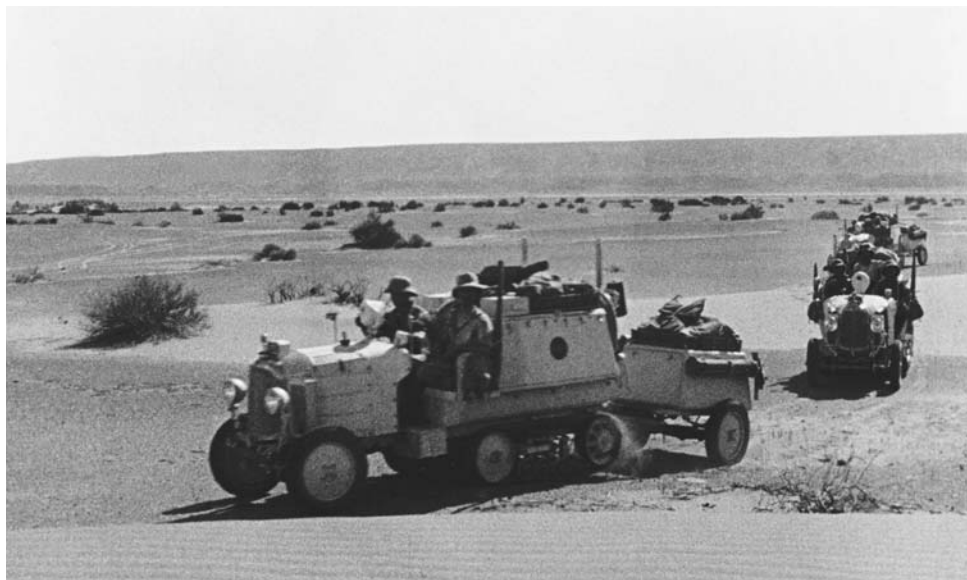
Bilerne der deltog i Afrika-eventyrene var alle baseret på B2 (B10 kom jo først i 1925), men var i høj grad specialbygget til formålet, bl.a. med længere chassissrammer. Her er det er gruppe fra Den Sorte Ekspedition, fotograferet i Sahara. Bemærk de enorme kølere på bilerne, der har typebetegnelsen P4T.
