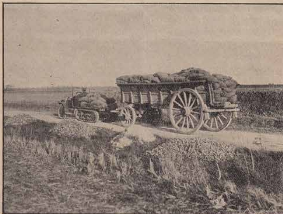
LE TRACTEUR CITROËN (PROPULSEURS KEGRESSE) REMORQUANT SUR ROUTE UN CHARIOT LOURDEMENT CHARGÉ (5.000 KILOS)
