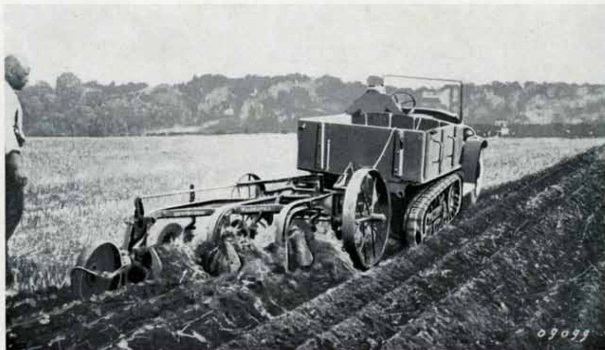
LA MÊME LABOURANT AVEC UNE CHARRUE TRISOC A 30 CENTIMÈTRES DE PROFONDEUR
