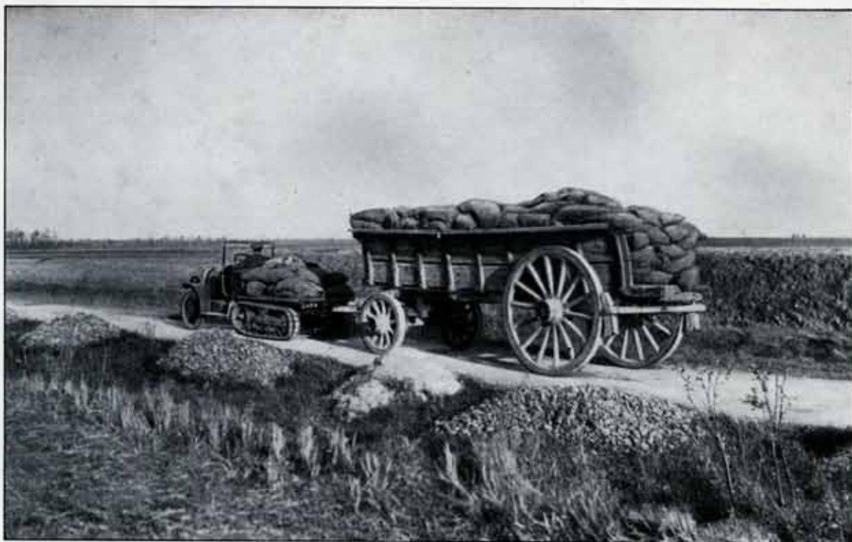
AUTOCHENILLE CITROËN REMORQUANT SUR ROUTE UN CHARIOT CHARGÉ A 5 TONNES
