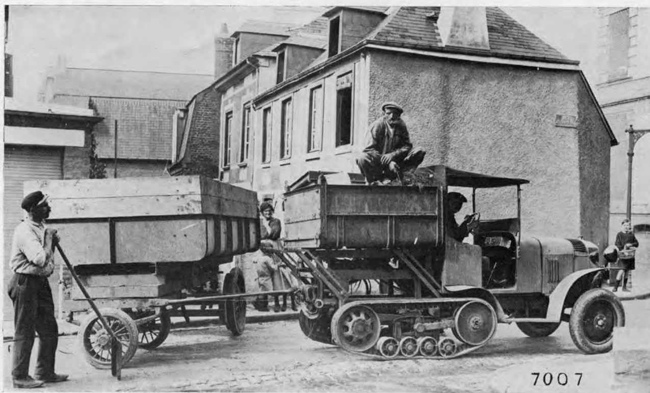
BENNE BASCULANTE ET REMORQUE POUR L'ENLÈVEMENT DES ORDURES MÉNAGÈRES (PROPULSEUR MODÈLE 1927)
