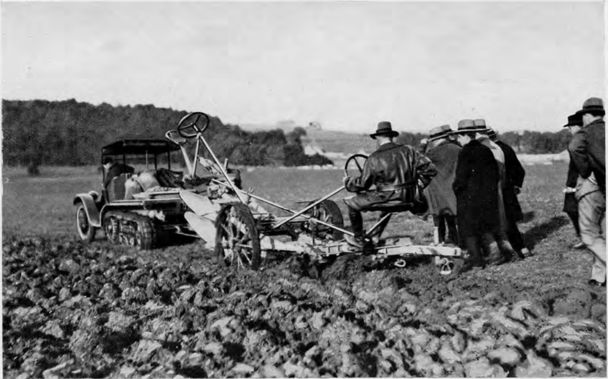
AUTOCHENILLE P-17 CITROËN LABOURANT AVEC UNE CHARRUE TRISOC A 30 CENTIMÈTRES DE PROFONDEUR
