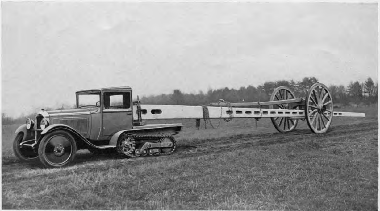
AUTOCHENILLE CITROËN REMORQUANT UN PYLONE D'ÉLECTRIFICATION A TRAVERS TERRES
